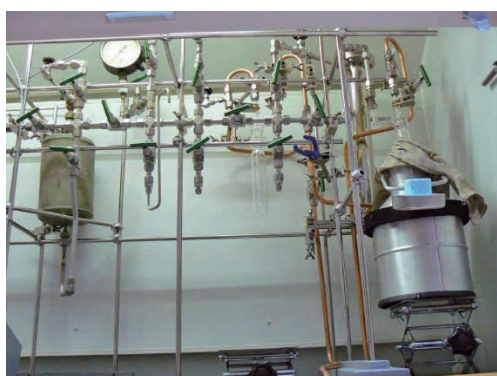
Fig. (左)耐フッ化物反応ライン。このような反応ラインとニッケルやパーフルオロプラスチック反応容器中でフッ化物の合成を行う。 (右)酸化フッ化物の合成スキーム。出発物質としてアルコキシド、酸化物、フッ化物を想定している。
